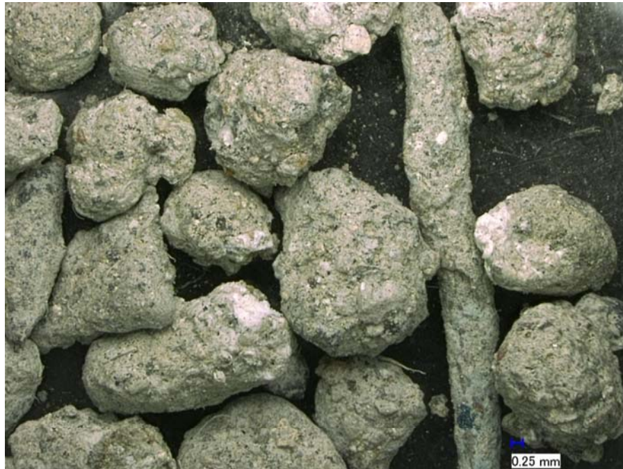
NE-Metalle aus MVA-Schlacke – Fraktion 2-4 mm (WSS), 20x Vergrößerung
